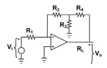
$R_1 = 2k\Omega$ ,  $R_2 = 1k\Omega$ ,  $R_3 = 15k\Omega$ ,  $R_4 = 6k\Omega$
