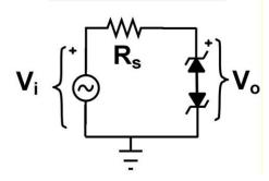
Tensión de salida limitada entre un máximo y/o un mínimo
