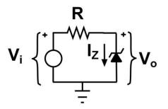
Tensión de salida constante (Zener en ruptura)
