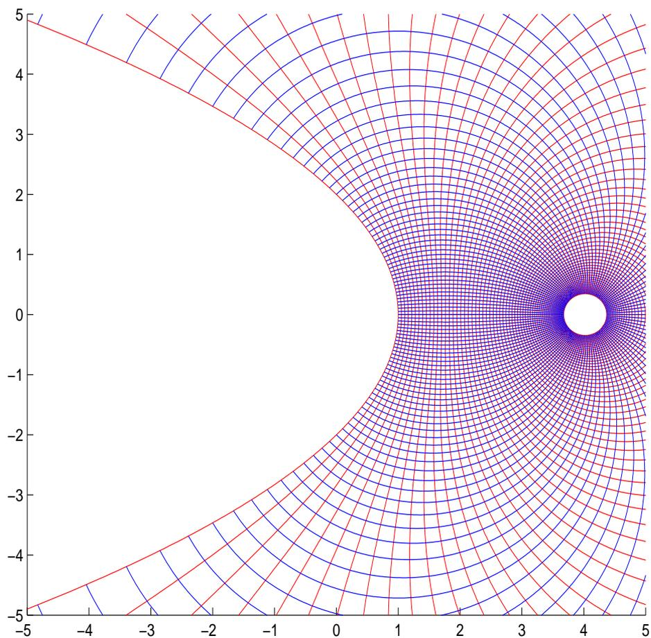
**Fig. 8.** Un mallado del exterior de una parábola. Se obtiene como imagen del mallado del disco unidad por la composición de la transformación  $T = \frac{1-W}{1+W}$ , que lleva  $\mathbb{D}$  en  $\mathbb{C}^+$ , y  $G = (T + 1)^2$ , que lleva  $\mathbb{C}^+$  en el exterior de la parábola  $x = 1 - \frac{y^2}{4}$ .
