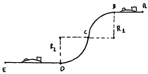
TRAMO AB: VUELO HORIZONTAL, rectilíneo, estacionario  $\Rightarrow \Delta E$
