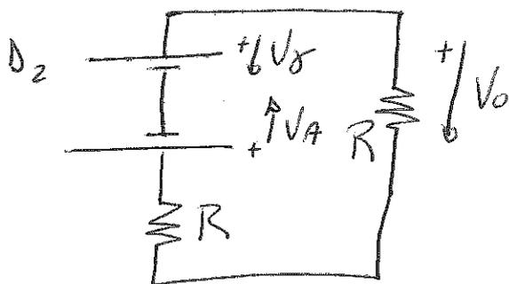
$$I \cdot R + V_A + V_o = V_{\gamma} \Rightarrow I = \frac{V_{\gamma} - V_A - V_o}{R}$$
