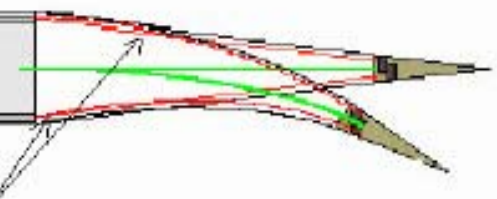
control de vuelo por flexión de las alas (sin alerones)
