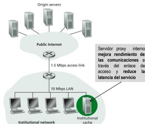
Servidor proxy interno mejora rendimiento de las comunicaciones a través del enlace de acceso y reduce la latencia del servicio
