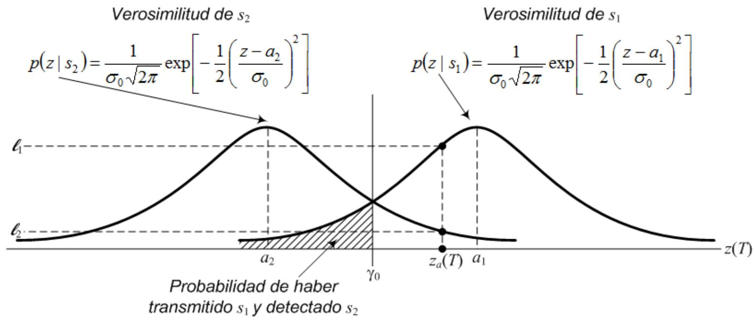
La demodulación es ligada a la energía de la señal y no a su forma, de hecho el filtro de recepción (*matched filter*) asocia a todas las señales con la misma energía el mismo valor de  $z(T)$ .  $z(T)$  representa el rango de posible valores de las muestras en la salida del demodulador, mientras que  $\gamma = \gamma_0$  representa el umbral de recepción óptima para
