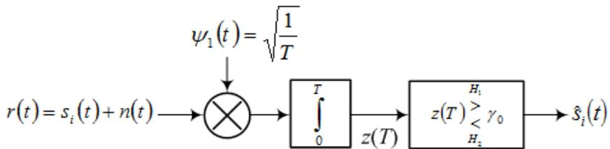
Utilizando  $\psi_1(t)$  como función de referencia es posible utilizar un único receptor tanto para señales bipolares como para señales unipolares.
