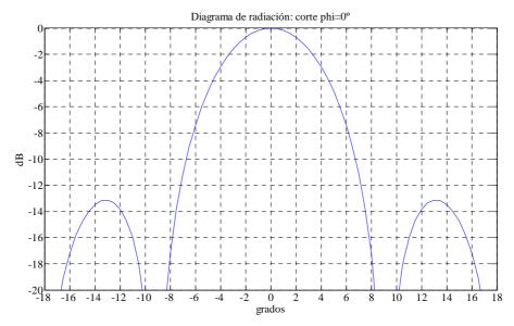
Se sabe que la temperatura de brillo del sol es de 6000K (con un arco de 0.5°), la del cielo de 30K y la de la Tierra de 290K. Determine la temperatura de ruido de la antena T<sub>A</sub>.
