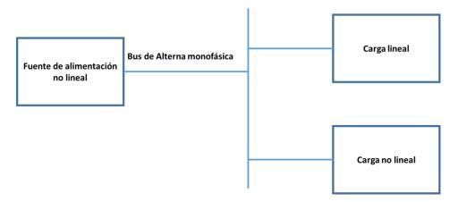
La fuente no lineal la caracterizamos con fuentes de tensión de los tres primeros armónicos ( $U_1$  (50 Hz) = 250V,  $U_3$  (150 Hz) = 70 V y  $U_5$ (250 Hz) = 12 V).
