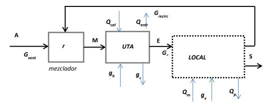
UTA $Q_{cal}$ Potencia calentador $Q_{Enfr}$ Potencia enfriador $g_h$ Caudal másico de agua en el humidificador $g_c$ Caudal másico de agua condensada
