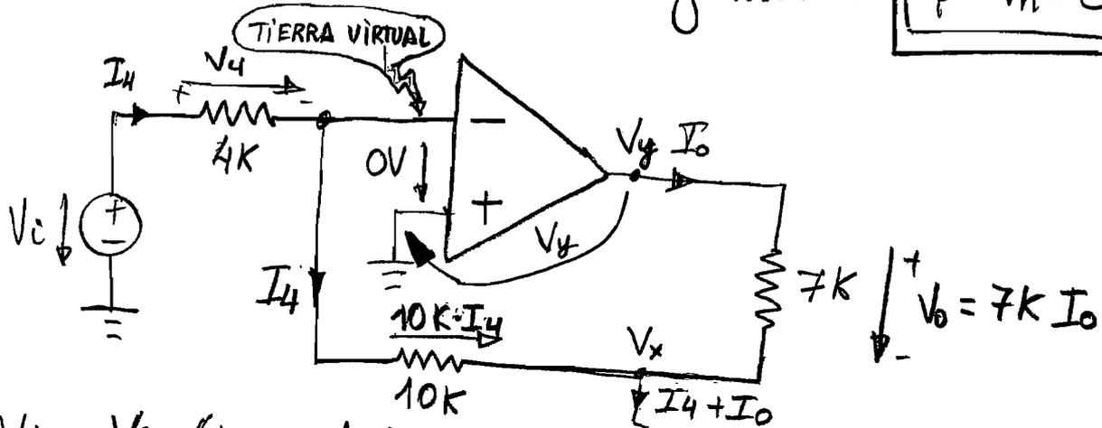
$$V_4 = V_i \quad (\text{tierra virtual en el terminal -})$$
