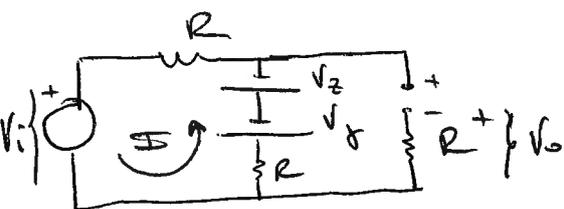
Si  $V_i \leq -8.2V \rightarrow V_o = 0V$  con  $D_3 \equiv \text{OFF}$   $Z_1 \equiv \text{RUP}$   $Z_2 \equiv \text{ON}$
