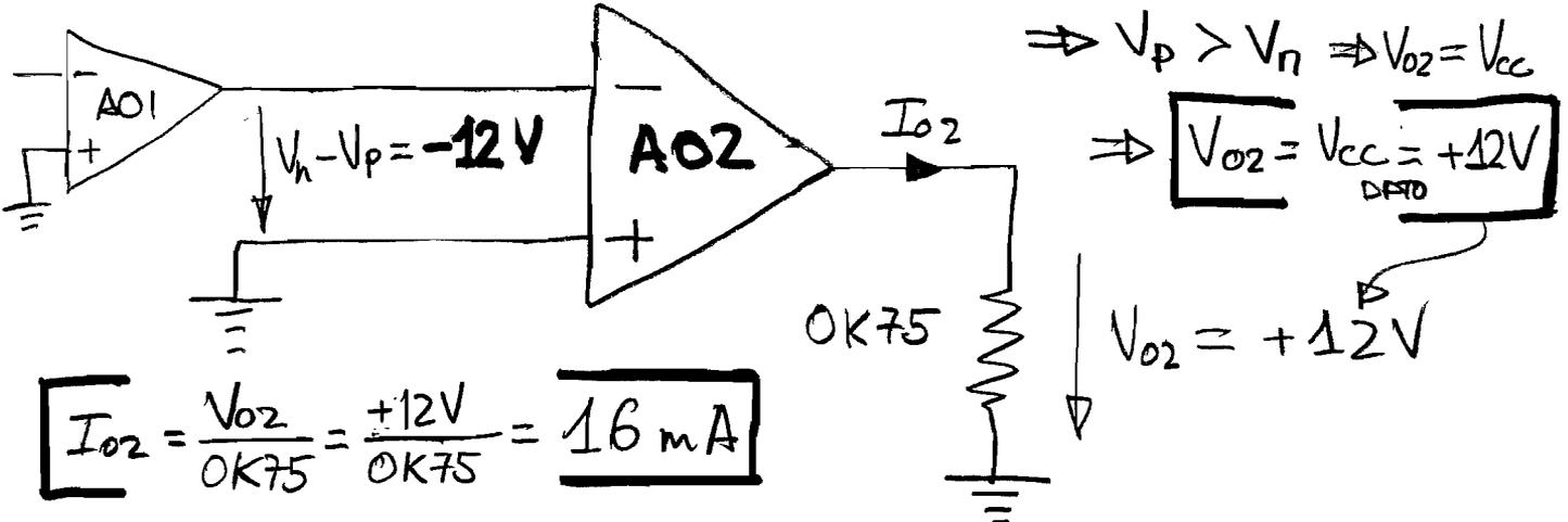
$I_{02} < I_{0,max} (=25 \text{ mA}) \Rightarrow$  El AO no limita por  $I_{g,max}$
