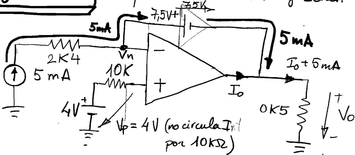
$$V_n = V_p = 4V \quad (\text{AO funciona como amplificador})$$
