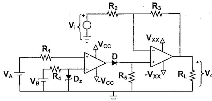
$R_1 = 500\text{ }\Omega$ ,  $R_2 = 600\text{ }\Omega$ ,  $R_3 = 1.8\text{ k}\Omega$ ; AO:  $V_{CC} = 5\text{ V}$ ,  $V_{XX} = 15\text{ V}$ ,  $I_{O,MAX} = 25\text{ mA}$
