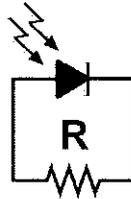
Al iluminar la zona de deplexión del fotodiodo, los pares electrón-hueco generados...
