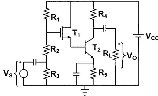
$v_S$  fuente de tensión alterna,  $V_{CC} = 15\text{ V}$ ,  $R_2 = 1.8\text{ k}\Omega$ ,  $R_3 = 2.6\text{ k}\Omega$ ,  $R_L = 3.2\text{ k}\Omega$
