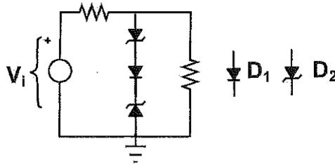
donde todos los diodos tienen una  $V_\gamma = 0.6\text{ V}$  y los zener una  $V_z = -5.6\text{ V}$ , la rama de diodos es equivalente a...
