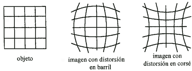
FIGURA 9.31. Distintos tipos de distorsión: en barril y en corsé.
