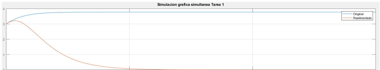
Figura 1: Representación del sistema original (azul) y el sistema realimentado (rojo) en función del tiempo (eje X) y la amplitud (eje Y).
