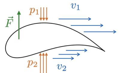
de modo que  $v_1 > v_2$  implica  $p_1 < p_2$ . Se produce por tanto una sobre presión debajo del ala que sustente el avión. Si  $A$  es la área del ala del avión, la fuerza hacia arriba es
