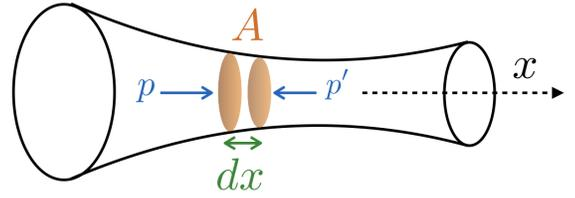
Tomando ahora un tubo de corriente con eje paralelo al eje  $x$ , y consideramos una rodaja de fluido de área  $A$  y espesor  $dx$ . La masa de la rodaja es  $dm = \rho A dx$ , donde  $\rho$  es la densidad del fluido.
