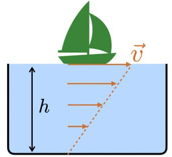
Los fluidos en régimen laminar incompresible y viscosidad constante, se llaman **fluidos Newtonianos**. Por un fluido Newtoniano, la fuerza de resistencia experimental por una placa de área  $S$  que se mueve, a velocidad constante  $v$  por la superficie de un fluido de profundidad  $h$  viene dada por
