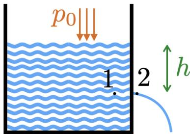
Como otro aplicación consideramos la velocidad de salida de un líquido por un orificio practicado en el tanque que lo contiene. Aplicando el teorema de Bernoulli a los puntos 1 y 2 situados a la misma altura del orificio dentro y fuera del tanque, tenemos
