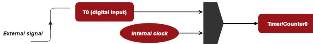
Si contamos pulsos de reloj a una frecuencia  $f_{CLK}$  (pulsos por segundo, Hz), cada pulso supone un periodo de tiempo  $T_{CLK}=1/f_{CLK}$ . La **relación** entre el valor de cuenta del circuito T/C (value) y el tiempo transcurrido es:
