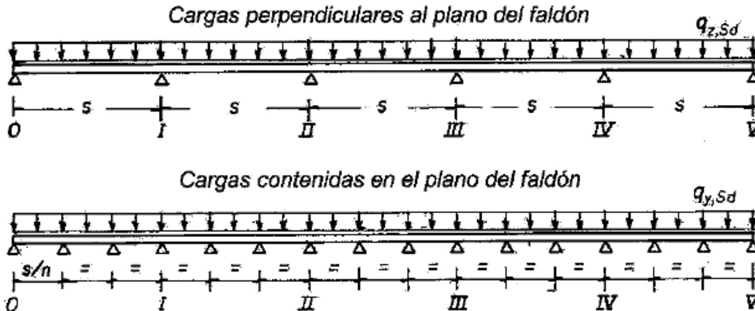
Esquema de cargas en las correas donde se han empleado tirantillas para reforzar en las cargas contenidas en el plano del faldón. Recordar que, además de garantizar la resistencia del material, también hay que tener en cuenta la flecha máxima ( $L/300$ ).
