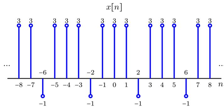
Una vez obtenidos dichos coeficientes se pide obtener la secuencia de salida  $y[n]$  del sistema de la siguiente figura cuando a la entrada tenemos la secuencia  $x[n]$  anterior. En el sistema de la figura,  $h[n]$  es la respuesta al impulso de un filtro paso alto ideal de pulsación de corte  $\Omega_c = \frac{\pi}{3}$ .
