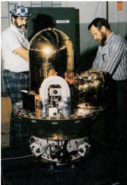
En 1976 se puso en órbita este reloj (dentro de una satélite a 10000 km) y sus medidas se comparaban con otro idéntico en la Tierra. Cumpliendo las predicciones de la TGR, **el reloj terrestre atrasaba 0.43 ns cada s respecto al reloj del satélite.**
