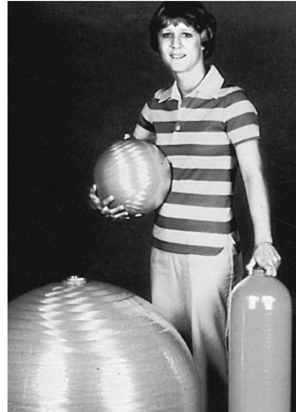
Recipientes a presión de aplicación aeroespacial de material compuesto polimérico reforzado con fibra de poliaramida
