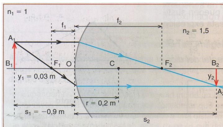
(b) Para calcular la distancia a la que se forma la imagen  $s_2$ , utilizamos la ecuación para la refracción en una superficie única,
