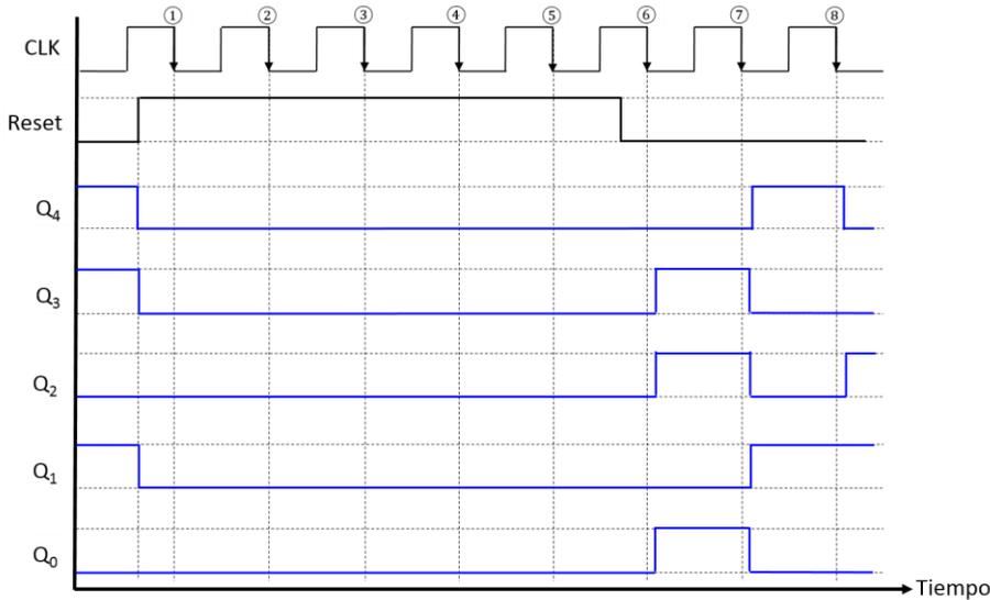
**U3\_21.** Dado el sistema secuencial de la figura adjunta, se pide completar el cronograma dado con la señal de salida de cada FF, sabiendo que la señal de reset es asíncrona.
