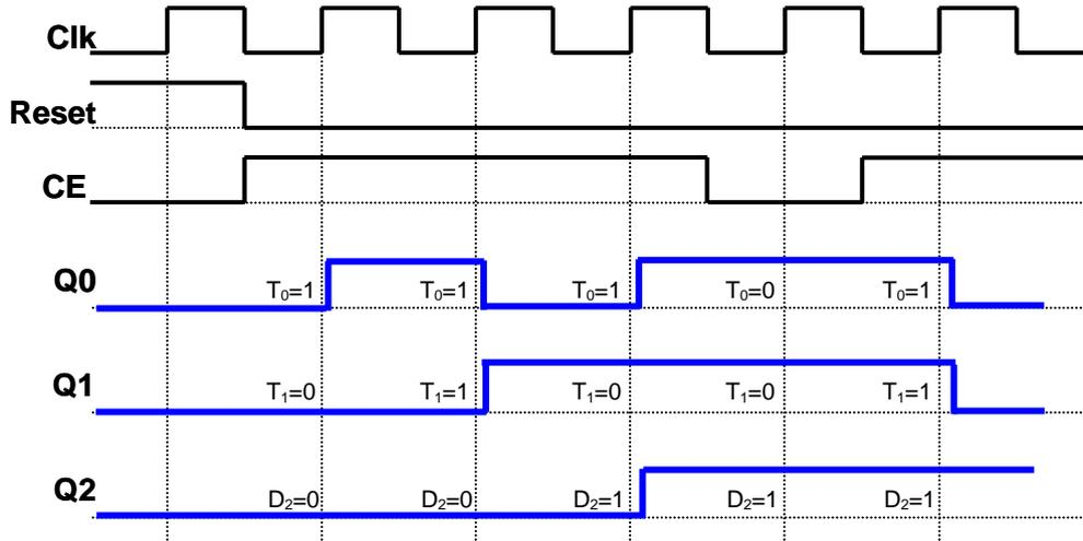
**U3\_9.** A partir del diagrama de la figura, se pide dibujar un cronograma para 5 ciclos de reloj completos. Los valores iniciales para los biestables son  $Q_0 = 0$ ,  $Q_1 = 1$  y  $Q_2 = 1$
