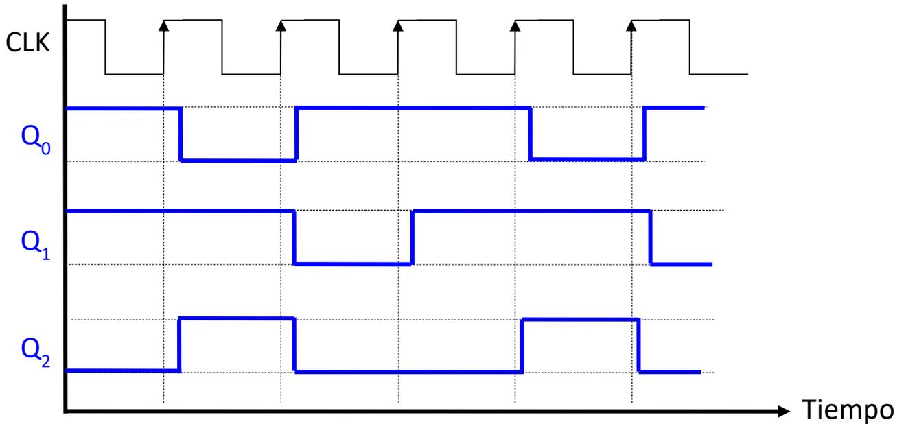
**U3\_16.** El registro de 4 bits de la figura, está formado por 4 FF de distinto tipo. Se pide completar el cronograma para las salidas  $Q_0$ ,  $Q_1$ ,  $Q_2$  y  $Q_3$ . Nota: El Reset es asíncrono.
