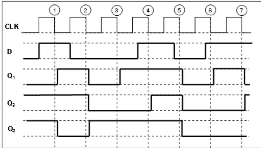
**U3\_5.** En el secuencial de la figura, se supone que inicialmente  $Q_0 = Q_1 = 1$  y  $Q_2 = Q_3 = 0$ . Dibuje en el diagrama de tiempos la señal de salida de los FF 1,2 y 3 e indicar razonadamente qué tipo de FF es el 0 (el primero a la izquierda). Los flip-flops se activan por flanco ascendente de reloj.
