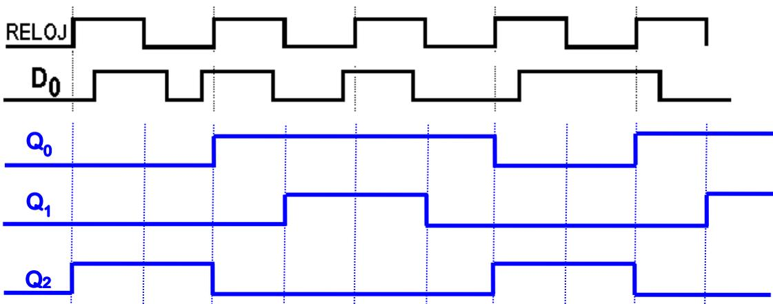
**U3\_4.** En los 4 biestables (FF) de la figura, se supone que inicialmente  $Q_0=Q_1=0$ ,  $Q_2=Q_3=1$ . Dibuje en un diagrama de tiempos, la señal de salida de cada flip-flop si la secuencia de entrada  $D$  se aplica a  $D_0$  sincrónicamente con el reloj. Observe que todos los FF se activan por flanco descendente de reloj.
