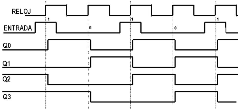
**U3\_2.** En el sistema secuencial de la figura, se supone que inicialmente  $Q_0 = Q_3 = 1$ ,  $Q_1 = Q_2 = 0$ . Dibuje en un diagrama de tiempos las señales de salida de los flip-flops 0, 1, 2 y 3 durante cinco ciclos de reloj.
