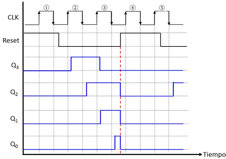
**U3\_23.** Dado el sistema secuencial de la figura adjunta, se pide completar el cronograma dado con la señal de salida de cada FF, sabiendo que la señal de Reset es asíncrona.
