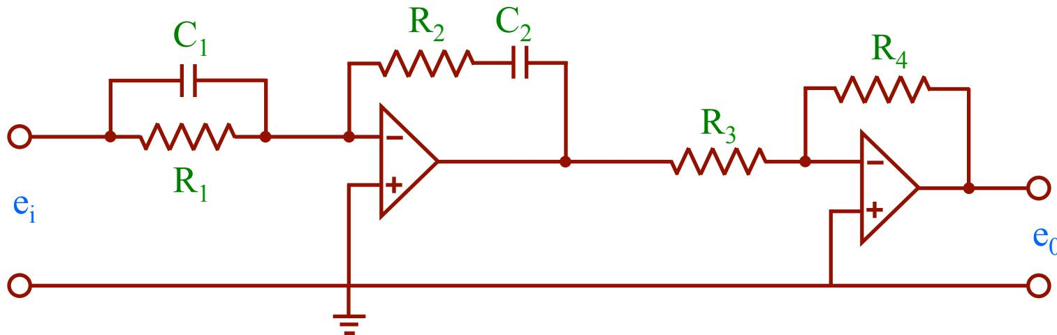
$$\frac{E_0(s)}{E_i(s)} = \frac{R_4 \cdot (R_1 \cdot C_1 + R_2 \cdot C_2)}{R_3 \cdot R_1 \cdot C_2} + \frac{R_4}{R_3 \cdot R_1 \cdot C_2 \cdot s} + \frac{R_4 \cdot R_2 \cdot C_1 \cdot s}{R_3}$$
