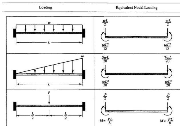
Esfuerzos cortantes y momentos flectores Se obtiene el momento flector y el esfuerzo
