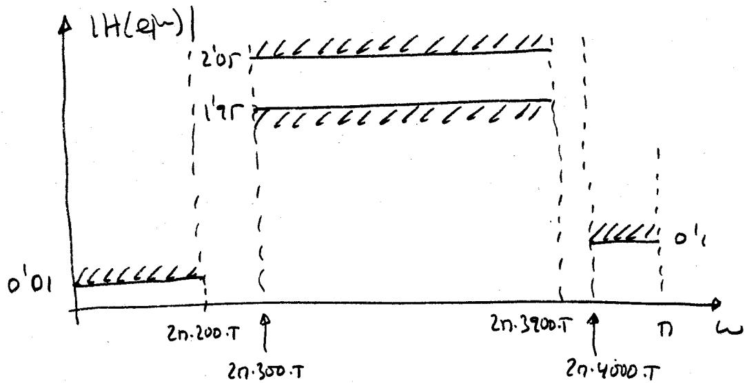
El principal problema que puede aparecer es que si tomamos un  $T$  demasiado grande la banda de paso puede empezar a salirse de los banda representables en frecuencias discretas (puede irse por encima de  $\pi$ ) con lo que el filtro de tiempo continuo equivalente tendrá un ancho de banda menor que el deseado.
