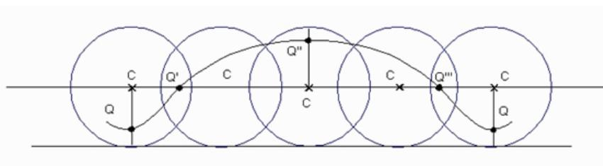
**Figura 7.28:** Trayectoria de un punto interior del sólido en rodadura.
