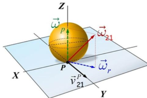
**Figura 7.23:** Velocidad angular de rodadura y pivotamiento.
