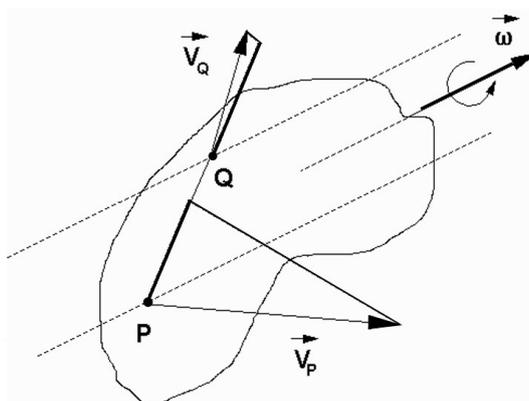
**Figura 7.6:** Proyección de la velocidad de dos puntos  $P$  y  $Q$  del sólido a lo largo de la recta que une dichos puntos.
