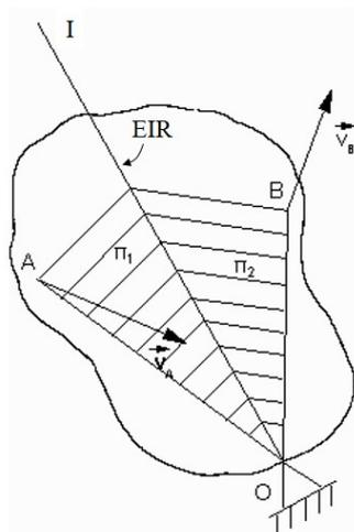
**Figura 7.14:** Movimiento del sólido con punto fijo.
