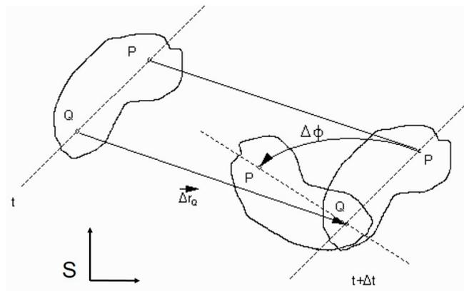
**Figura 7.12:** Descripción del movimiento entre dos posiciones sucesivas en el movimiento plano general.
