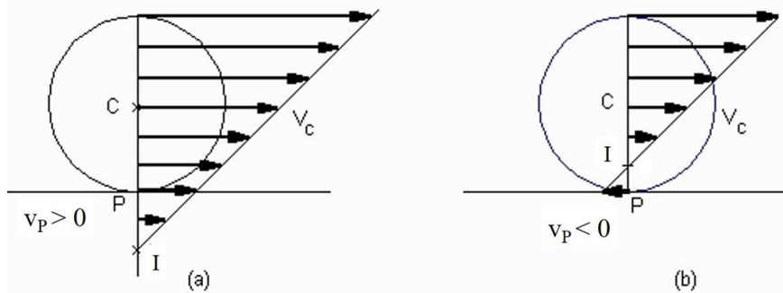
Figura 7.30: Campo de velocidades para la rodadura con deslizamiento.
