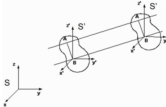
**Figura 7.7:** Movimiento plano de traslación rectilínea.
