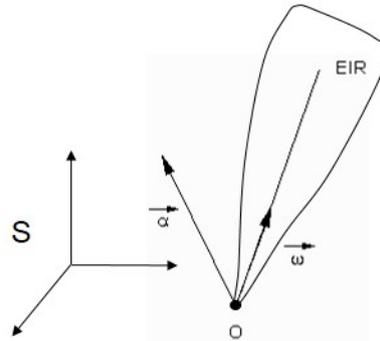
**Figura 7.15:** Variables cinemáticas angulares en el movimiento del sólido con punto fijo.
