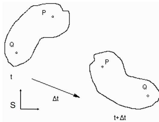
Figura 7.11: Movimiento plano general de un sólido.
