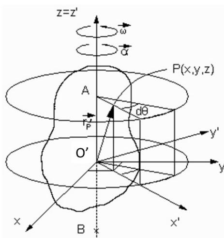
**Figura 7.10:** Ángulo girado por un sólido respecto a un eje fijo.
