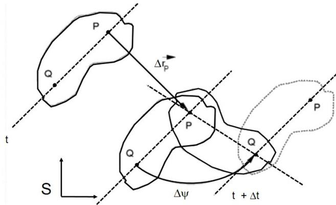
**Figura 7.13:** Descripción del movimiento entre dos posiciones sucesivas en el movimiento plano general.
