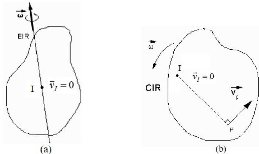
**Figura 7.19:** a) Eje instantáneo de rotación. b) Centro instantáneo de rotación.
