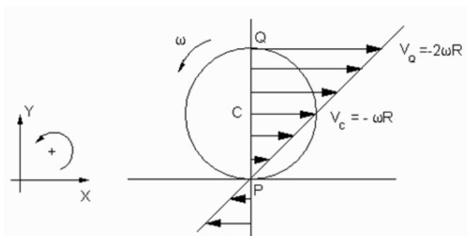
Figura 7.25: Variables en rodadura pura.
