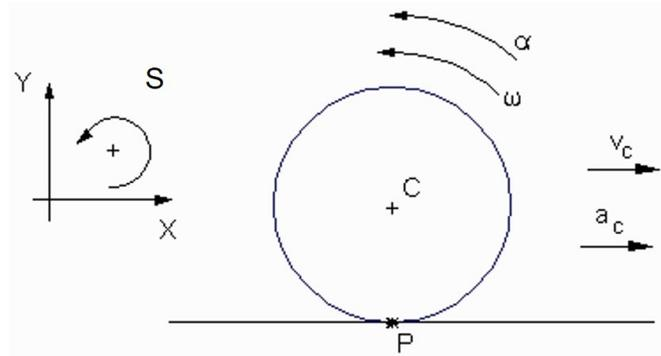
Figura 7.24: Rodadura plana.
