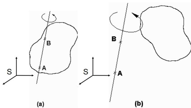
**Figura 7.9:** Movimiento plano de rotación alrededor de un eje fijo.
