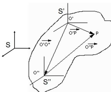
**Figura 7.4:** Dos sistemas ligados al sólido y posición de un punto  $P$  de éste en ambos.
