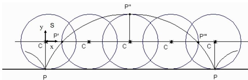
Figura 7.27: Trayectoria de un punto del perímetro del sólido en rodadura pura.
