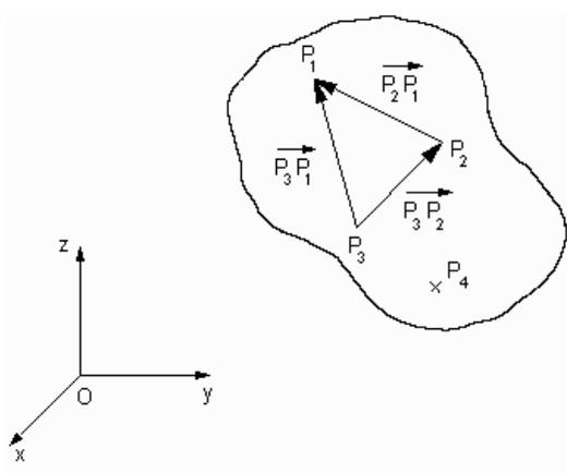
**Figura 7.1:** Distancia entre partículas en un sólido rígido.
