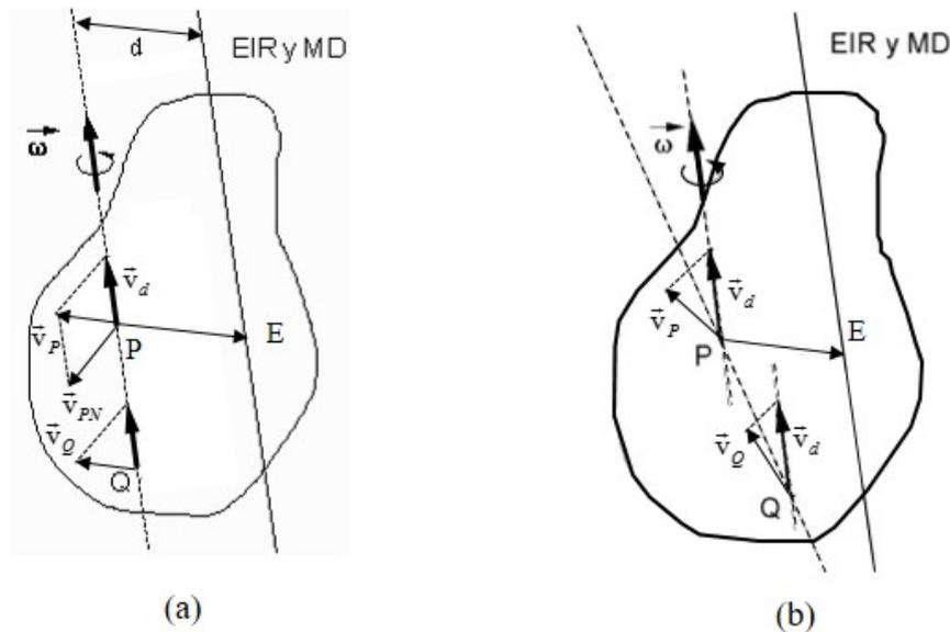
**Figura 7.21:** Determinación gráfica del EIRyMD: a) caso  $\vec{v}_P = \vec{v}_Q$  y b) caso  $\vec{v}_P \neq \vec{v}_Q$ .
