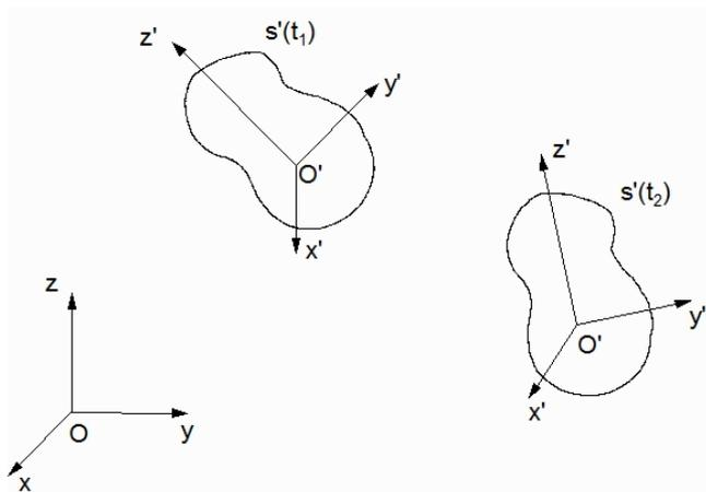
**Figura 7.2:** Sistema  $S'$  ligado al sólido en dos instantes de su movimiento.
