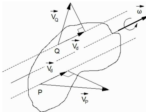
**Figura 7.5:** Proyección de la velocidad de dos puntos del sólido en la dirección de la velocidad angular.
