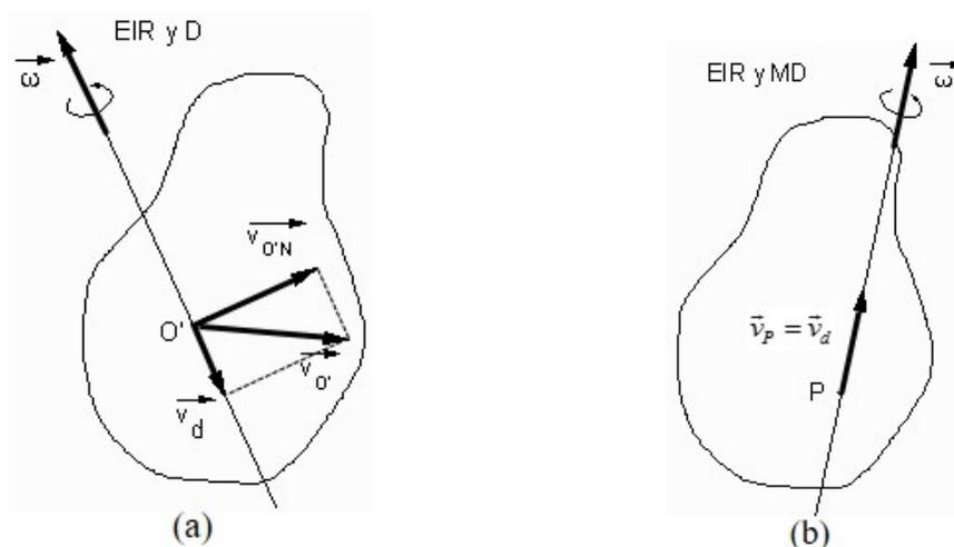
**Figura 7.18:** a) Eje instantáneo de rotación y deslizamiento.
