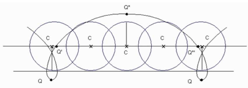
**Figura 7.29:** Trayectoria de un punto exterior al sólido y ligado a éste en rodadura.
