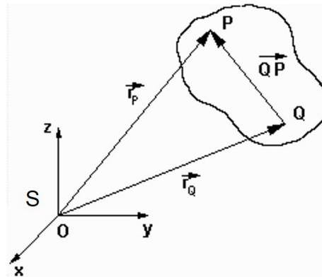
**Figura 7.8:** Variables usadas en un movimiento de traslación plana.
