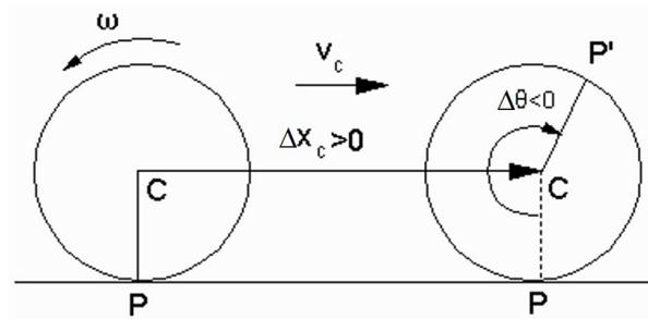
Figura 7.26: Variables en rodadura pura.
