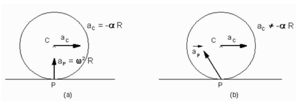
Figura 7.31: Aceleración del punto de contacto en a) rodadura y b) rodadura con deslizamiento.
