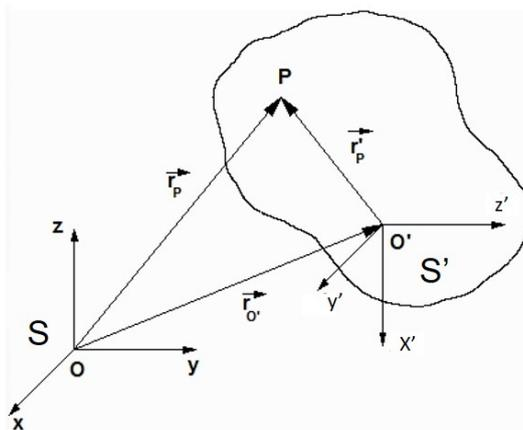
**Figura 7.3:** Sistemas fijo y ligado al sólido y posición de un punto  $P$  de éste en ambos.
