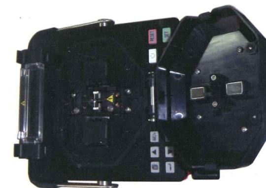
Figura 6.76. Fusionadora de fibra óptica.
