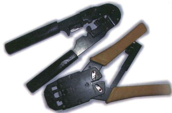
Figura 6.44. Herramientas de presión (crimpadoras).
