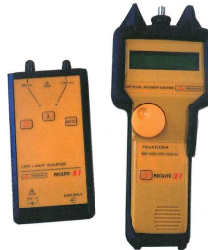
Figura 6.84. Fuente de luz y medidor de potencia.
