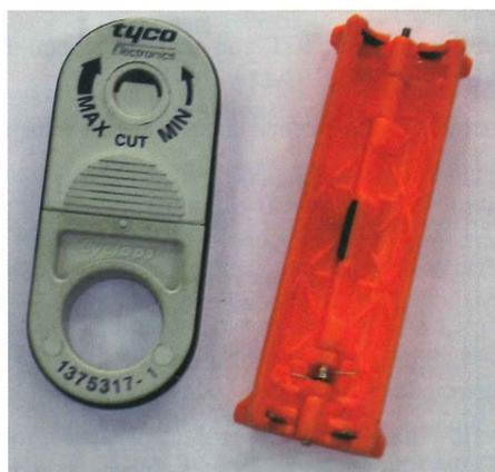
Figura 6.12. Peladora de cable.
