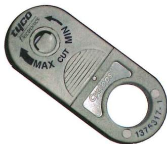
Figura 6.43. Herramientas específicas para pelar cables.
