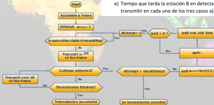
Esquema del proceso de transmisión en CSMA/CD
