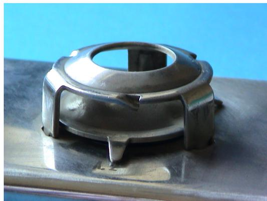
**Figura 5.9:** Válvula Ballast A.2 de Glitsch, con caja
