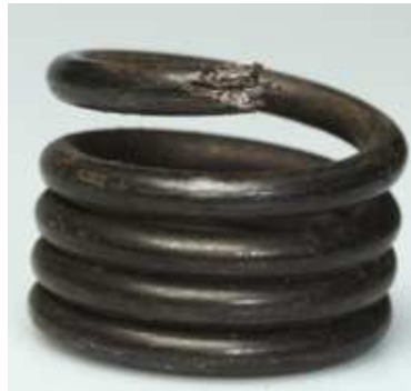
Figura 5.6 - Rotura por fatiga de un resorte helicoidal
