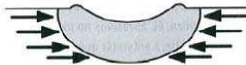
Figura 4.4 – La compresión se opone a la fisura
