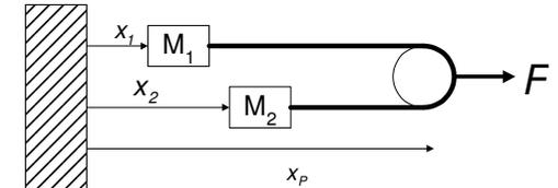
Figura 5) Posiciones de cuerpos conectados a través de una polea móvil
