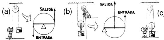
Figura 2) Efectos del uso de polea. (a) cambio de orientación de una fuerza; (b) multiplicación de su efecto; (c) ambas cosas a la vez
