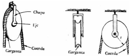
Figura 1) Partes de una polea
