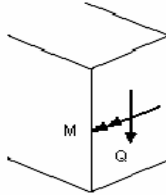
Fig. 5.7 Fuerza Cortante y Momento Flector
