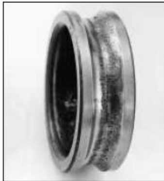
42: Deterioro avanzado por fatiga en un rodamiento rígido de bolas
