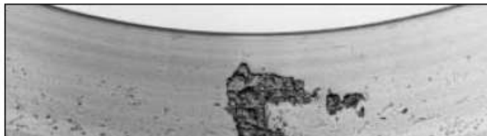
41: La fatiga clásica se pone de manifiesto en los hoyuelos (pitting) del camino de rodadura del aro interior de un rodamiento rígido de bolas. En la fase de deterioro avanzada se produce exfoliación de material en todo el camino de rodadura.
