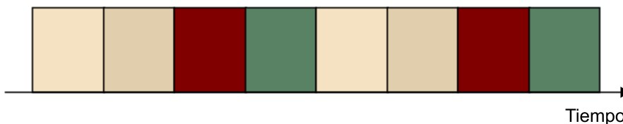
Figura 16. Representación del acceso múltiple por división de tiempo (TDMA)
