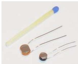
Dispositivo resistivo que disminuye el valor de su resistencia al incrementar la intensidad de la luz
