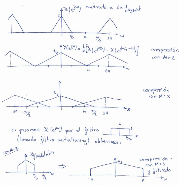
aunque hemos perdido frecuencias tras filtrar, nos hemos ahorrado el aliasing, no solapándose los espectros Si no existiese aliasing, el filtro será totalmente transparente, luego lo pondremos siempre antes de un compresor.
