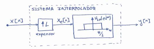
expansor: mete L-1 "0" entre muestra y muestra  $Xe[n] = \sum_{k=-\infty}^{+\infty} X[k] J[n-kl] = \begin{bmatrix} X[n/L] & n=0, \pm L, \pm 2L... \\ 0 & resto \end{bmatrix}$
