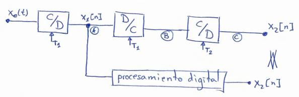
En  $\triangle$  tenemos una señal  $x_e(t)$  muestreada a  $\int_{S1} = \frac{1}{T_2} : x_1[n]$ En  $\triangle$  tenemos la misma señal en tiempo continuo En  $\triangle$  tenemos la señal  $x_c(t)$  muestreada a  $\int_{S2} = \frac{1}{T_2} : x_2[n]$ Hemos cambiado la frecuencia de muestreo
