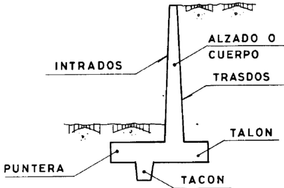
•CÁLCULO Y DIMENSIONAMIENTO DE MUROS
