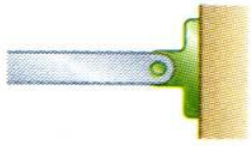
Articulación sin fricción, bisagra
