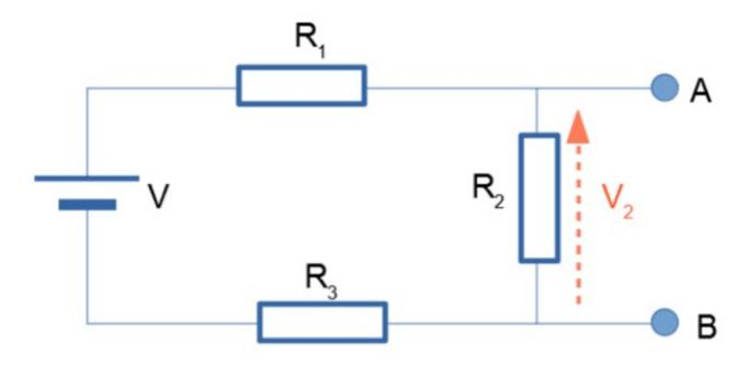
El objetivo en esta sección será calcular nominalmente el valor de V2 y, luego, simular el circuito para verificarlo.
