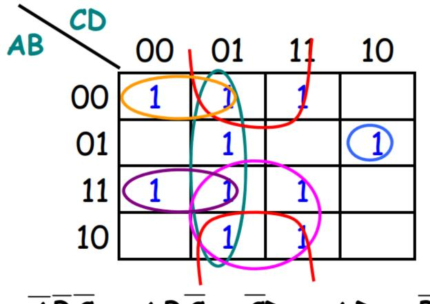
$$F = \overline{ABCD} + \overline{ABC} + \overline{ABC} + \overline{CD} + \overline{AD} + \overline{BD}$$
