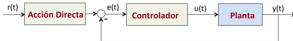
Permite ajustar la señal de control  $u(t)$  para que la salida  $y(t)$  siga a una versión conformada de la referencia. Se utiliza, por ejemplo, para introducir filtros que suavicen los cambios bruscos de la señal de referencia.
