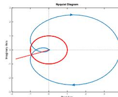
El diagrama de Nyquist, salvo por los tramos de radio infinito (asociadas a los semicírculos infinitesimales que esquivan los polos sobre el eje imaginario) representa, en el plano complejo, como varía  $GH(jw)$  y  $GH(-jw)$  para distintos valores de  $w$ .
