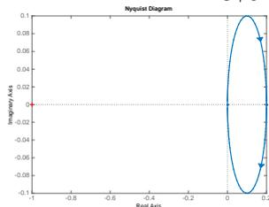
$P=0$ , Estable  $\forall K$ , ya que  $P=0$  y  $N=0$  porque el diagrama nunca engloba a un punto  $-\frac{1}{K}$ .
