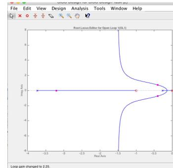
Con el ejemplo se puede observar como, según cambia la posición de los polos y los ceros del sistema original cambia la forma del lugar de las raíces.
