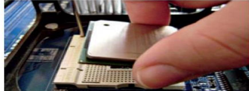
↑ Orientación y colocación del microprocesador (3 y 4).
