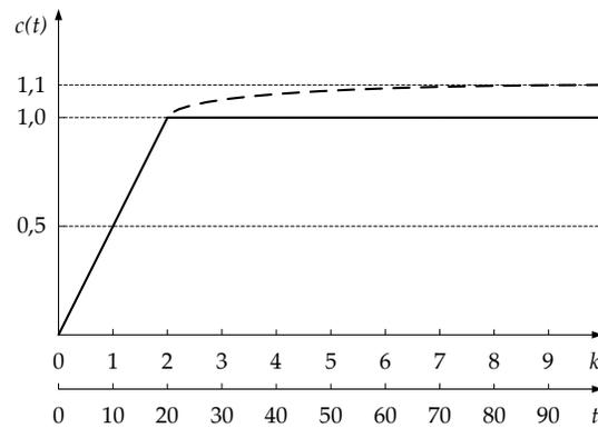
**Figura 3:** Señal  $c(t)$  deseada en respuesta a una entrada escalón unidad.
