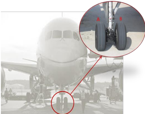
Figura 1. Vista frontal del tren de aterrizaje delantero
