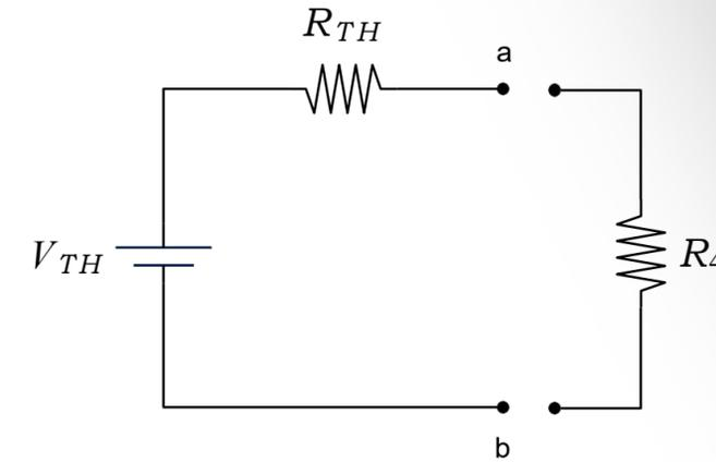
$$R_{TH} = \frac{R_1 R_3}{R_1 + R_3} + R_2$$
