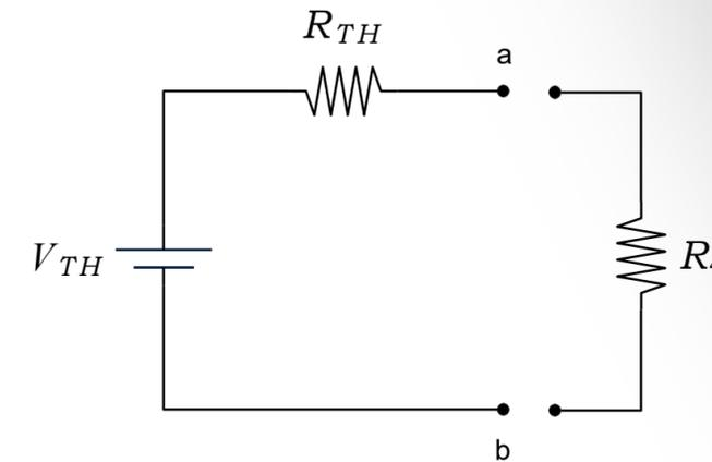
Cálculo de  $V_{TH}$  (removiendo  $R_4$ )
