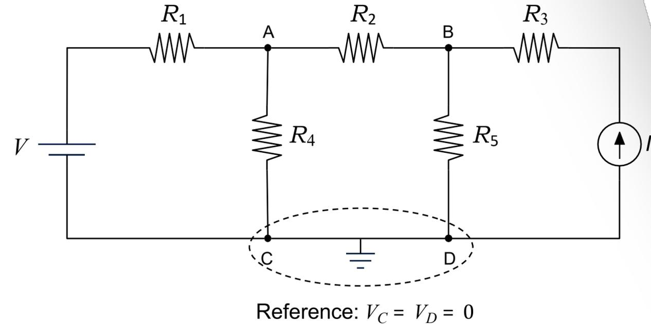
$$\text{NA: } \frac{V_A - V}{R} + \frac{V_A}{R} + \frac{V_A - V_B}{R} = 0 \quad \Rightarrow \quad 3V_A - V_B = V$$
