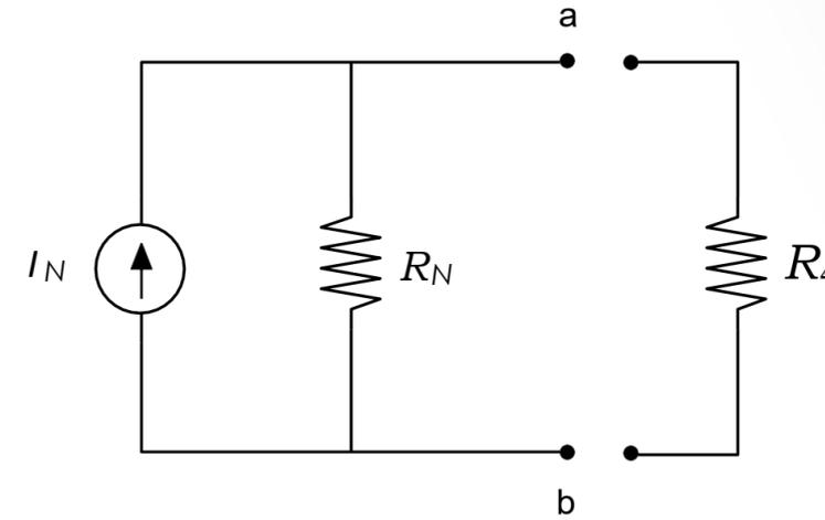
Cálculo de  $R_N$  (removiendo  $R_4$  y cortocircuitando  $V_1$ )
