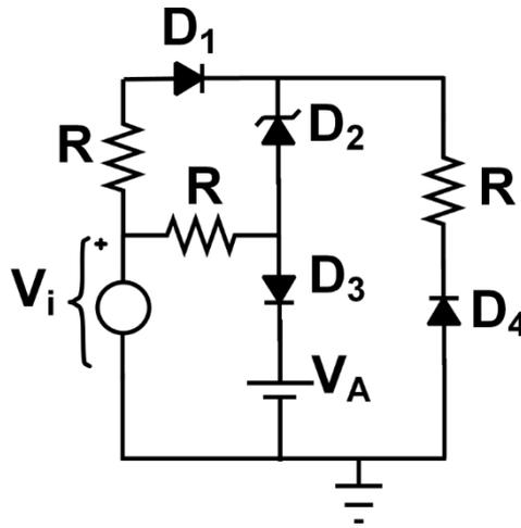
Nota: La secuencia de estados no depende de los valores de la tensión umbral, tensión zener, tensión  $V_A$  (siendo este positivo) ni del valor de la resistencia, por lo que si se prefiere se puede solucionar para unos valores concretos. Por ejemplo: tensión umbral  $V_y = 0.7$  V, tensión zener  $|V_z| = 3.3$  V,  $V_A = 6$  V y  $R = 1$  k $\Omega$ .
