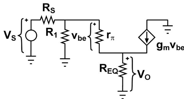
Donde  $R_{EQ} = R_2 \parallel R_L \parallel r_o$ . Si no incluimos efecto Early,  $r_o$  equivale a un circuito abierto y, por lo tanto,  $R_{EQ}|_{r_o=\infty} = R_2 \parallel R_L$ . Además incluir efecto Early reduce la resistencia equivalente ya que  $R_{EQ} < R_{EQ}|_{r_o=\infty}$ , porque tres resistencias en paralelo equivalen a un resistencia menor que el equivalente de dos de esas resistencias. Los parámetros que me piden estudiar son:
