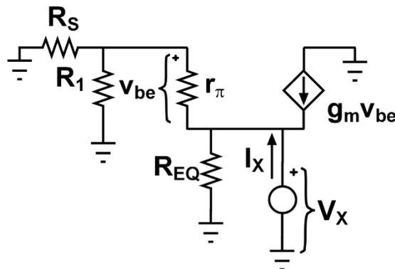
En este circuito la  $R_L$  hay que cambiarla por un circuito abierto, por lo que incluyendo efecto Early  $R_{EQ} = R_2 || r_o$ , y sin efecto Early,  $R_{EQ}|_{r_o=\infty} = R_2$ . También se cumple que la resistencia equivalente es menor con efecto Early:  $R_{EQ} < R_{EQ}|_{r_o=\infty}$ .
