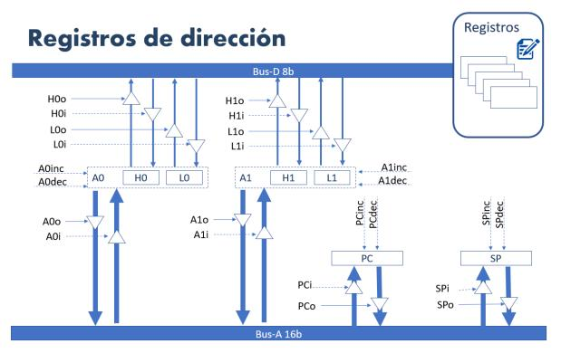
Como se ha dicho previamente, los bytes (H0, L0, H1, L1) de los registros A0 y A1 pueden ser manejados independientemente, por lo que, al igual que los registros de datos, son controladas por las señales de flanco y nivel equivalentes.
