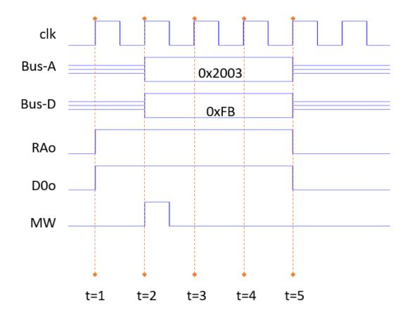
En t=1 la UC activa las señales RAo y D0o que provoca que los registros RA y D0 vuelquen su contenido en el BUS-A y BUS-D respectivamente.
