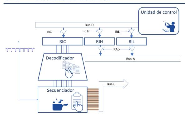
La unidad de control está formada por el decodificador alimentado por el registro RIC, y el secuenciador que descarga sobre el bus de control BUS-C
