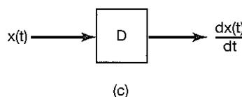
**Figura 2.29** Un conjunto posible de elementos básicos para la representación en diagrama de bloque del sistema descrito por la ecuación (2.128): (a) un sumador; (b) multiplicación por un coeficiente; (c) un diferenciador.
