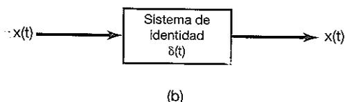
**Figura 2.26** Concepto de un sistema inverso para los sistemas LTI continuos. El sistema con respuesta al impulso  $h_1(t)$  es el inverso del sistema con respuesta al impulso  $h(t)$  si  $h(t) * h_1(t) = \delta(t)$ .
