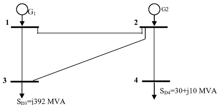
Solución: a)  $310 - i10$  MVA b)  $520 + i1$  MVA c)  $3 - i180$  MVA d)  $610 + i500$  MVA
